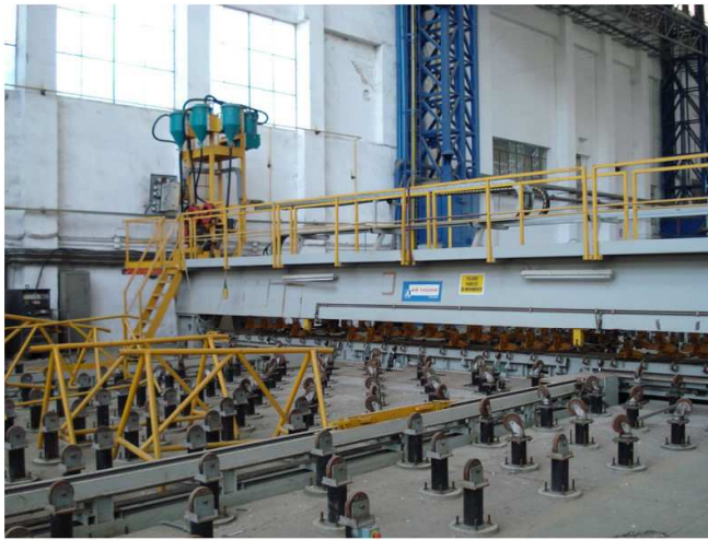
Estación de Soldadura de Paneles por una sola cara
